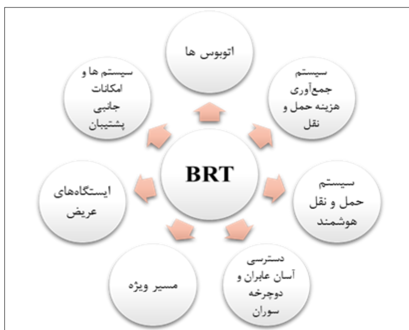
شکل ۱. اجزاء تشکیل دهنده سامانه اتوبوس‌های تندرو
